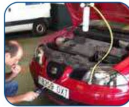
Fuga en condensador.
