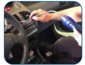
Fuga en evaporador.
