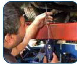
Fuga en eje de compresor.
