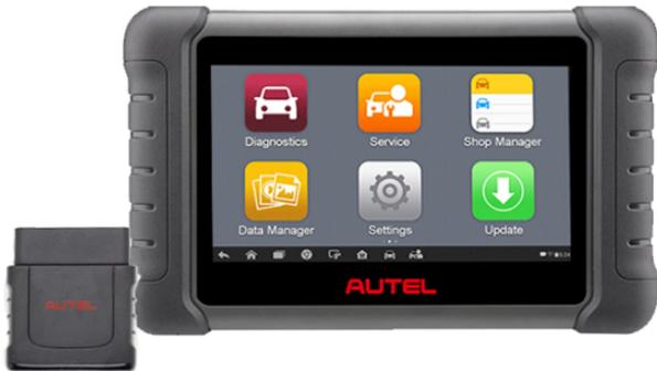
Autel presenta MaxiDAS DS808BT, una tablet de pantalla táctil de 7 pulgadas basada en Android, con amplia cobertura en diagnósticos de nivel OEM.
